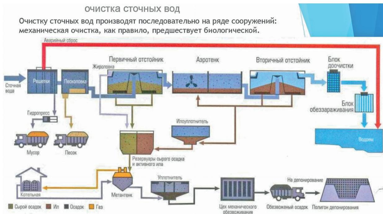
Рисунок. Очистка сточных вод
